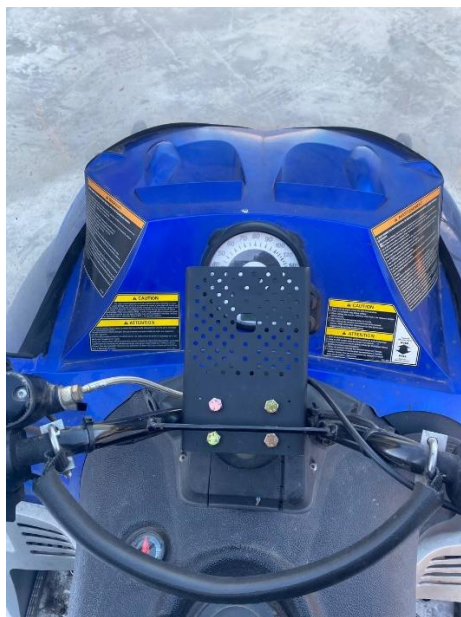
Рис. 7 Установка монтажной пластины.
